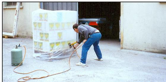
*Emballage thermo rétractile des cartons re-palettisés après la pose des languettes*
